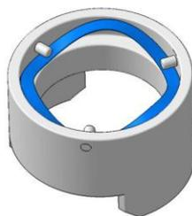
Empurre o corpo da vedação de anel deslizante para dentro do cárter da bomba de forma que as saliências de arrasto engatem nos entalhes previstos para o efeito. Os entalhes estão em linha com as aberturas para drenagem.
