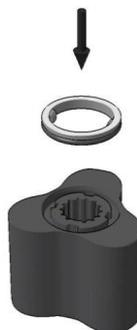
Desengordure as superfícies deslizantes e coloque os rotores.
