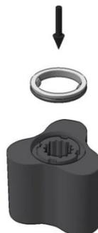
Dégraissez les surfaces de glissement et insérez les rotors.
