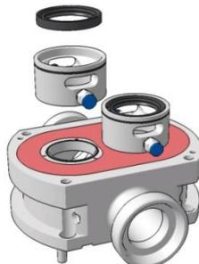
Posez le boîtier de paliers dans le boîtier de pompe. Soyez très prudent traversant les arbres: les joints radiaux peuvent être endommagés facilement.
