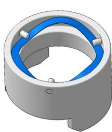
Poussez le boîtier des garnitures mécaniques d'étanchéité dans le boîtier de pompe de manière que les goupilles enchaînent dans les échancrures prévues à cette fin. Les échancrures sont dans une ligne avec les ouvertures de fuite.
