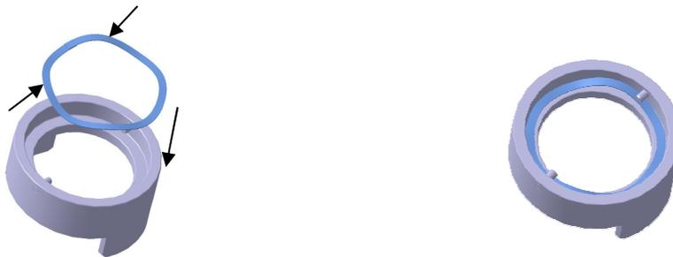
Poussez le boîtier des garnitures mécaniques d'étanchéité dans le boîtier de pompe de manière que les goupilles enchaînent dans les échancrures prévues à cette fin. Les échancrures sont dans une ligne avec les ouvertures de fuite.
